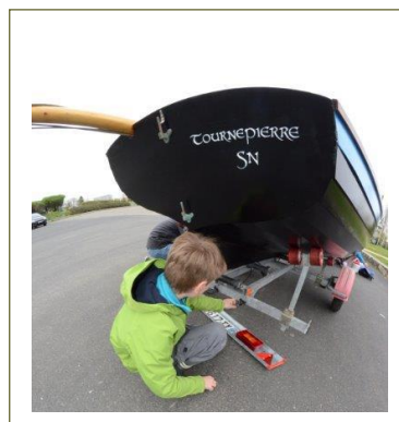
Si aucune lumière ne fonctionne ou qu'elles sont toutes faiblardes, c'est sans doute un problème de masse.
